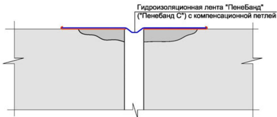
Рисунок 7.3.13 - Монтаж гидроизоляционной ленты «Пенебанд» («Пенебанд С»)
