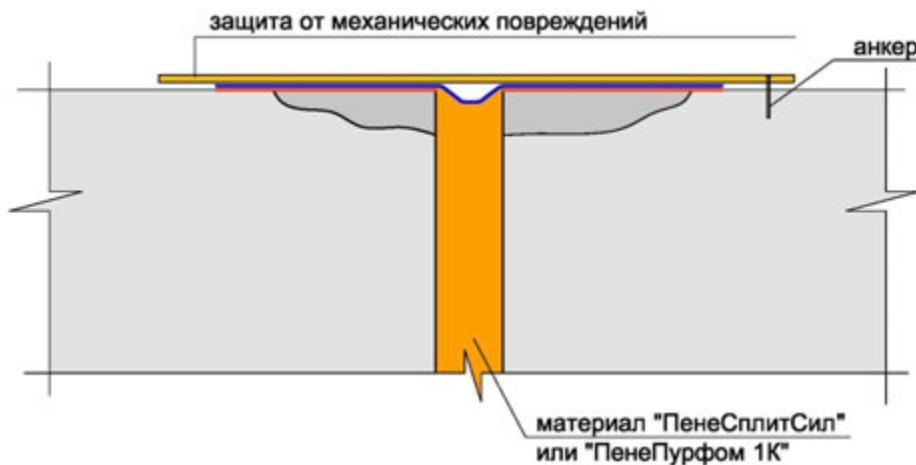
Рисунок 7.3.16 – Защита ленты от механических воздействий
