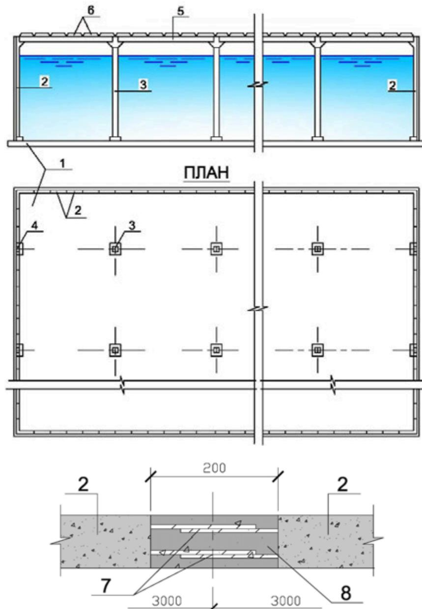
**Рисунок 6.4.2 - Схема прямоугольного резервуара из сборных железобетонных панелей:**
