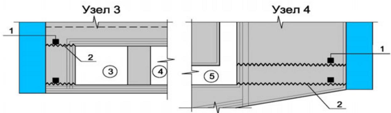
**Рисунок 7.1.11 - Типовые узлы гидроизоляции в потернах, цементационных галереях и соединительных коридорах (узлы 3 и 4 на рис. 7.1.10):**
