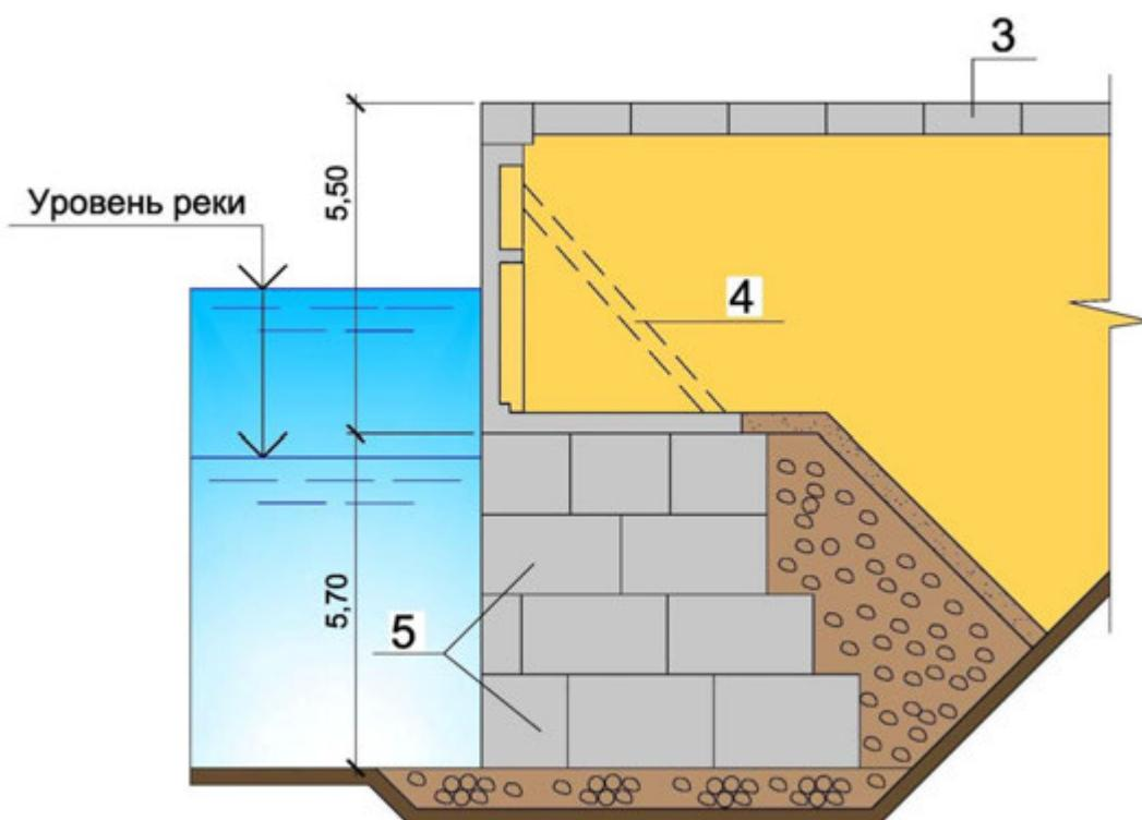
**Рисунок 6.5.2 - Конструкция причального сооружения из массивной кладки с надстройкой:**
