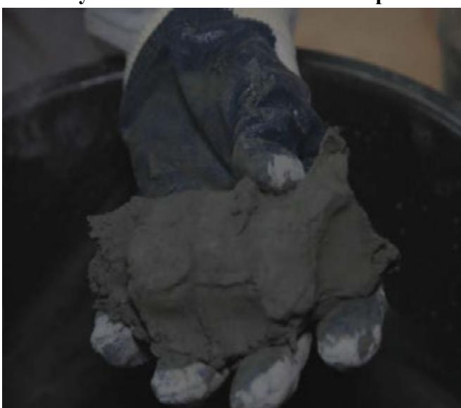
**Рисунок 7.2.25 – Приготовление растворной смеси «Скрепа М500 Ремонтная»**
