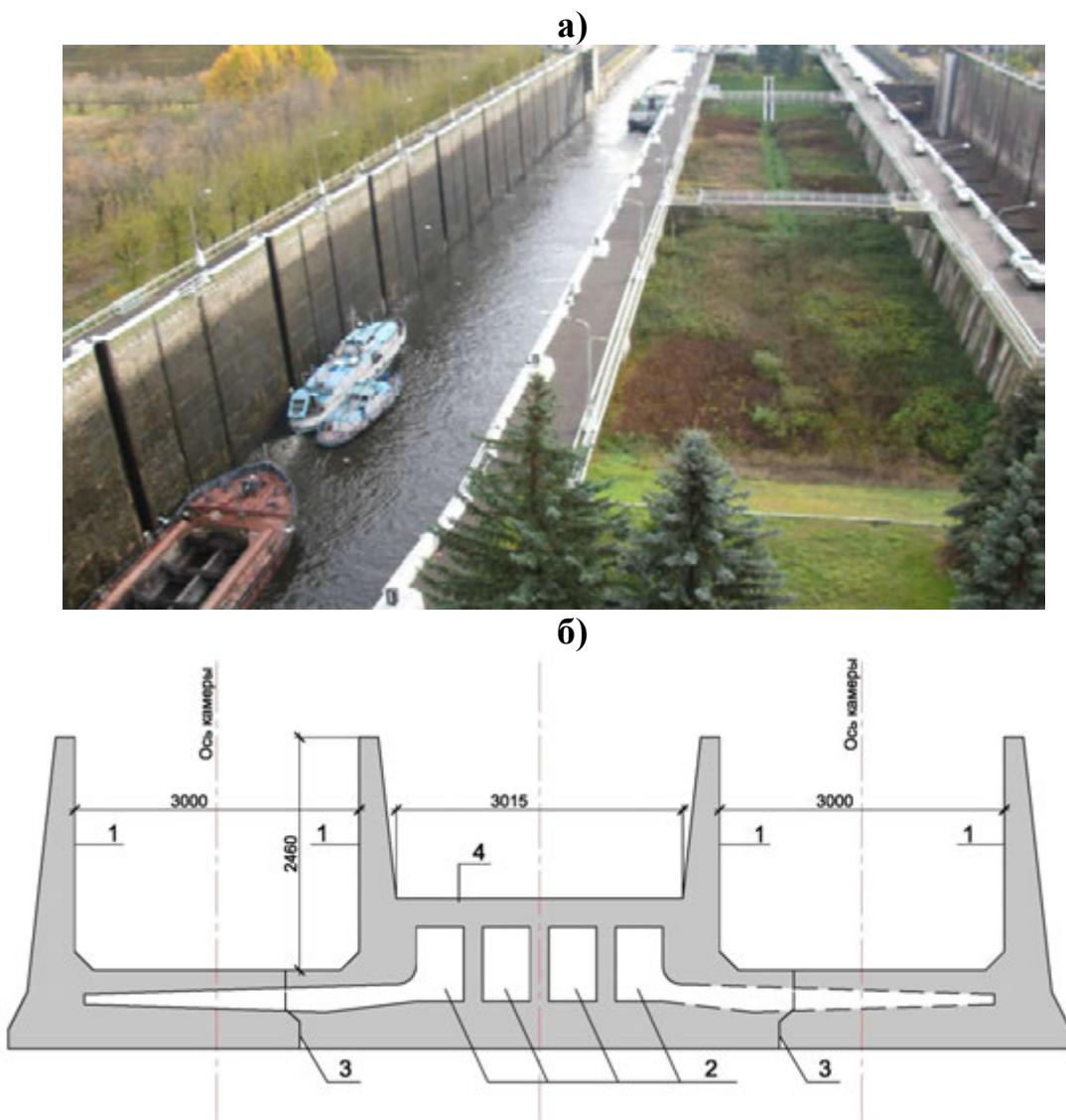
**Рисунок 6.3 - Двухниточный судоходный шлюз:**
