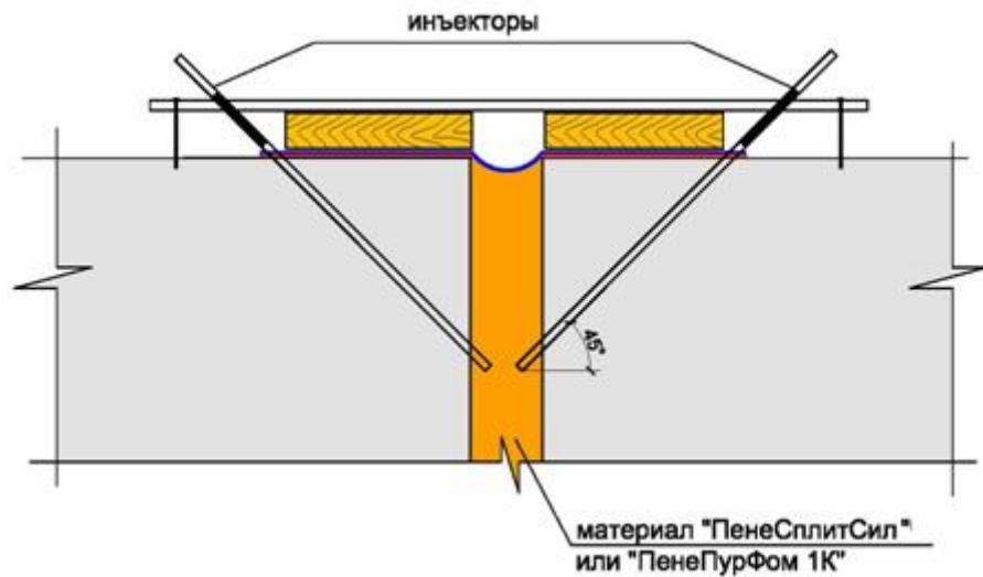
Рисунок 7.3.15 - Заполнение полости шва инъекционными смолами
