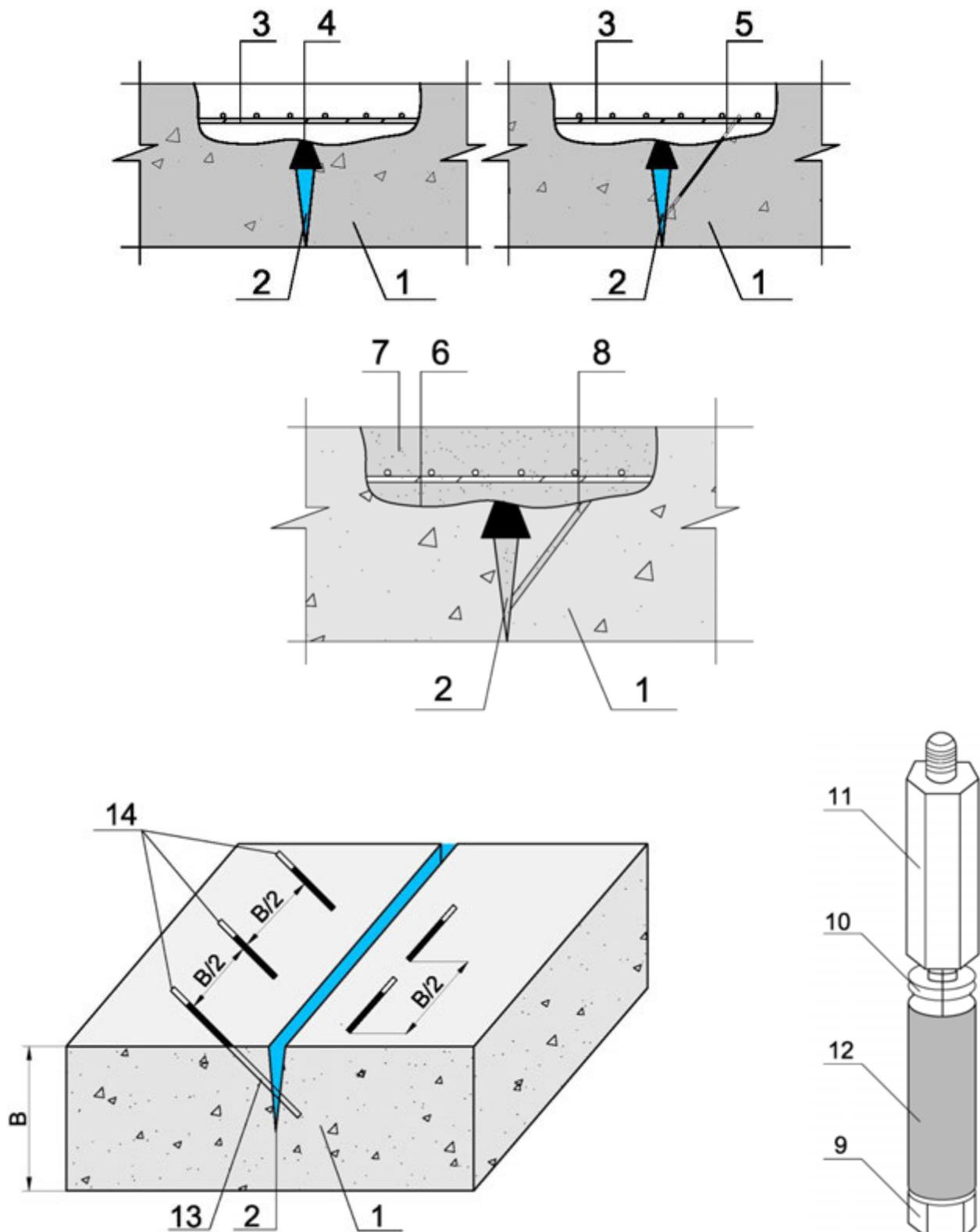
**Рисунок 7.4.9 - Заполнение каверн, пустот и полостей в железобетонных конструкциях:**
