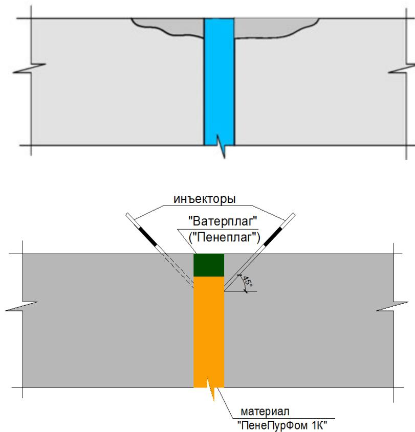
Рисунок 7.3.17 - Устранение течей через полость деформационного шва.
