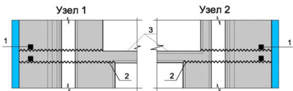
**Рисунок 7.1.9 - Типовые узлы гидроизоляции в машинном зале технологических помещений (узлы 1 и 2 на рис. 7.1.8):**
