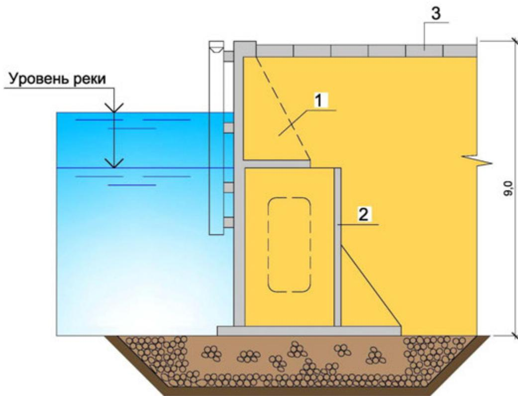
**Рисунок 6.5.1 - Конструкция причального сооружения из железобетонных массивов-гигантов:**
