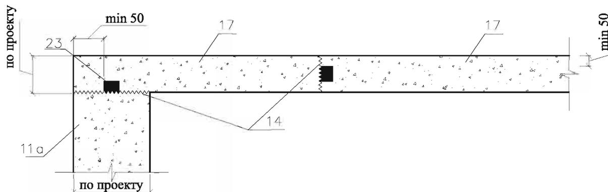
примечание: расстояние от места установки гидропрокладки пенебар до одного из краёв конструкции должно быть не менее 50 мм
