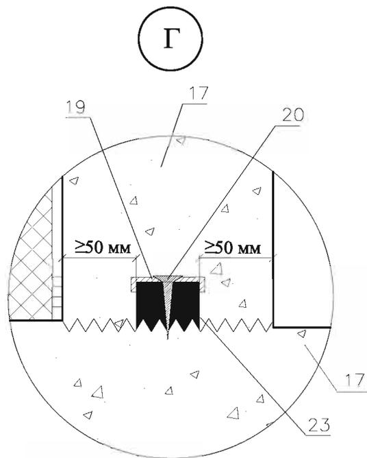
примечание: расстояние от места установки гидропрокладки пенебар до края конструкции должно быть не менее 50 мм
